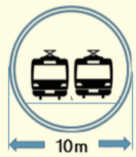
複線シールド 鉄道用地内
